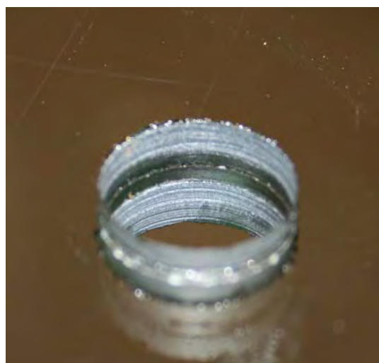
Foro eseguito con foretti per CNC. Notare la minima sbeccatura ed il plastico ben tagliato e non strappato.
